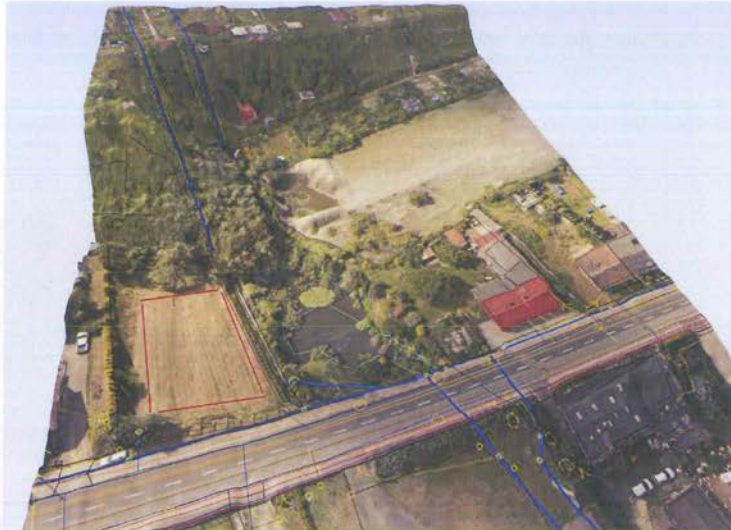
8. Przebudowa odcinka kanalizacji ujściowego od ul. Staromiejskiej do wylotu W3.5 do rzeki Kłodnicy w km 40+820 z likwidacją bajpasa.
